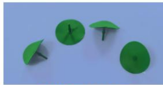
S1250伞形直径：32mm 阀杆直径：2.4mm 扣柱高度：4.1mm 伞面厚度：0.25mm
