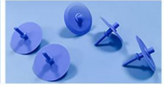
S1773伞形直径：19mm 阀杆直径：2.5mm 扣柱高度：3.2mm
