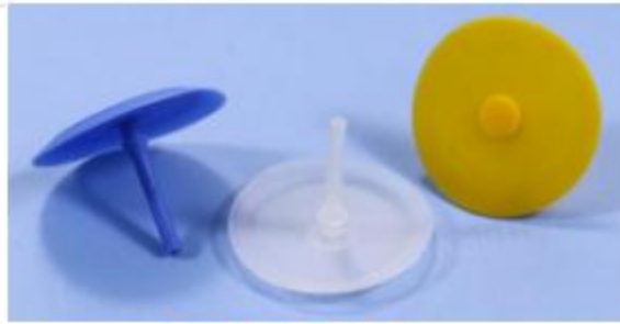
S202伞形直径：24mm 阀杆直径：2.5mm 扣柱高度：2.5mm 伞面厚度：0.7mm
